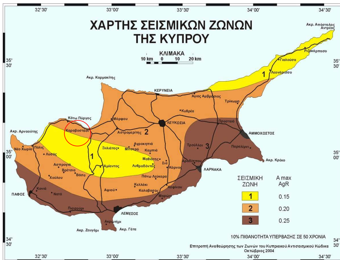
Εικόνα 6: Σεισμικές Ζώνες της Κύπρου - Η περιοχή «Π» για Πιθανή Δημιουργία Νέας Λατομικής Ζώνης
